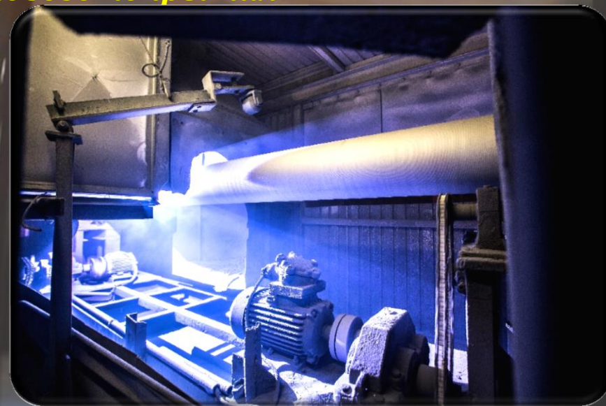
Нанесение цинкового покрытия
