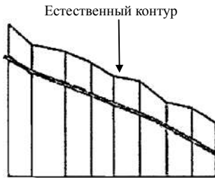
Рисунок 5.5 Трубопровод с постоянным уклоном.
