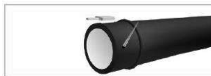
1. Очистка и смазка гладкого конца трубы
