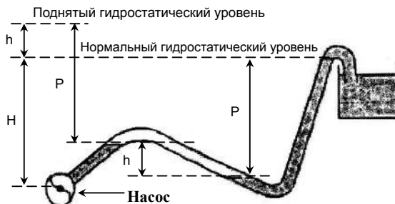
Рисунок 5.4 Условия в напорном трубопроводе.
