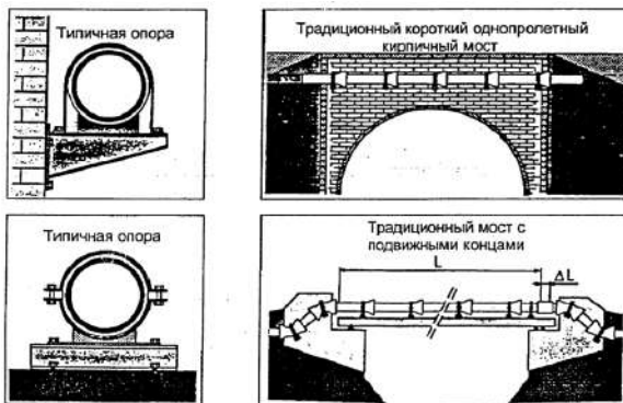
Рисунок 6.32 Трубопровод, закрепленный на сооружении.
