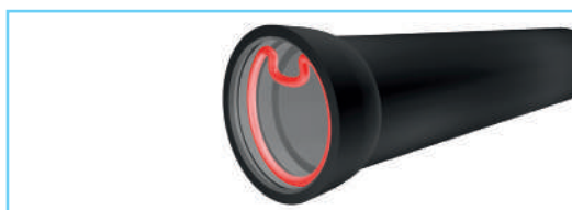
5. Установка уплотнительного кольца в раструб
