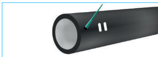
3. Смазка наружной поверхности гладкого конца трубы
