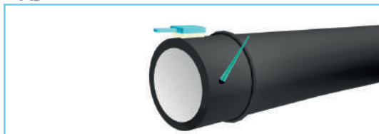
1. Очистка и смазка гладкого конца трубы
