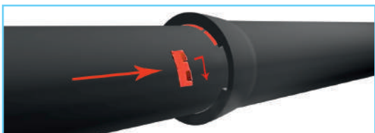
6. Стыковка труб и установка стопоров
