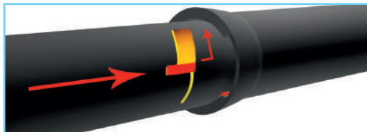
6. Установка левого стопора. Фиксация стопорной проволокой
