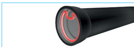
5. Установка уплотнительного кольца в раструб
