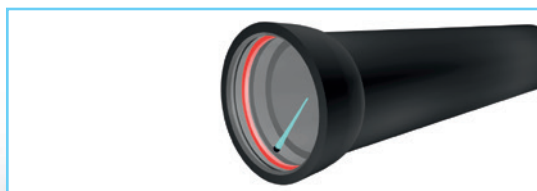
6. Смазка внутренней поверхности уплотнительного кольца
