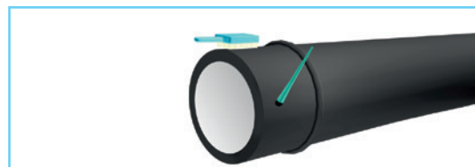
1. Очистка и смазка гладкого конца трубы
