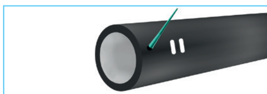
3. Смазка наружной поверхности гладкого конца трубы
