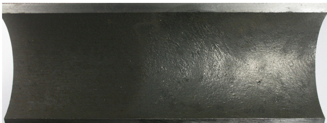
Вид внутренней поверхности по нижней образующей трубы из ВЧШГ («ЛТК «Свободный сокол») после 1 года промышленных испытаний в ООО «РН-Ставропольнефтегаз»
