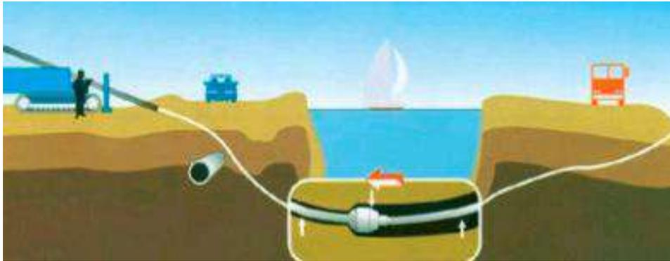
Рисунок 6.19 Расширение скважины.
