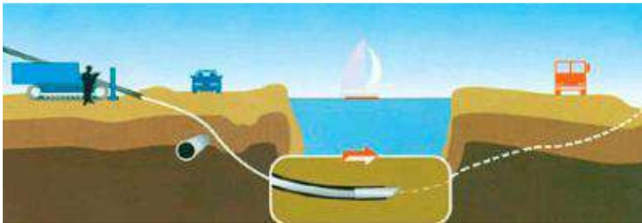
Рисунок 6.18 Бурение пилотной скважины.
