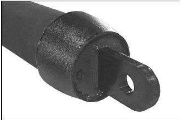
Рисунок 6.21 Приспособление для протягивания труб.
