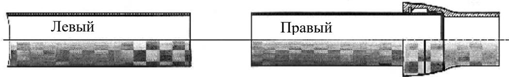
Извлечь из раструба оставшийся правый кусок трубы и установить на него ПФРК с уплотнительным кольцом. Предварительно ослабить гайки на шпильках для снятия усилий с резиновых уплотнителей.
