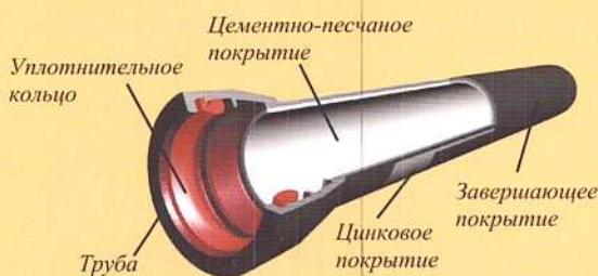
Для канализационных сетей различного назначения предлагаем раструбные трубы и фасонные части из ВЧШГ под следующие типы соединений:
